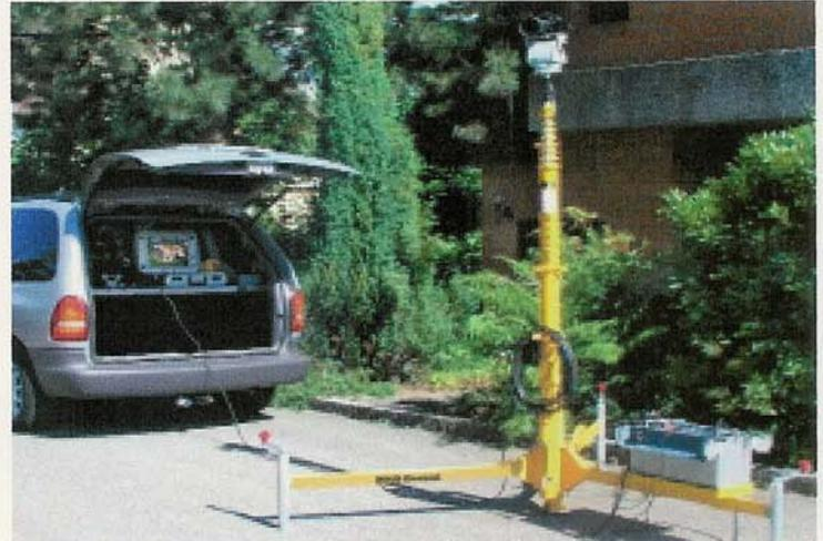
Die mobile Einheit, bestehend aus Mast, elektrischem Neigekopf und Steuerung hat Hans Auer selbst entwickelt.
